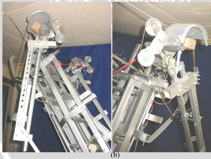
**Gambar 4.8** a) Ukuran Mekanik bahu dan lengan; b) Prototipe meaknik bahu dan lengan
