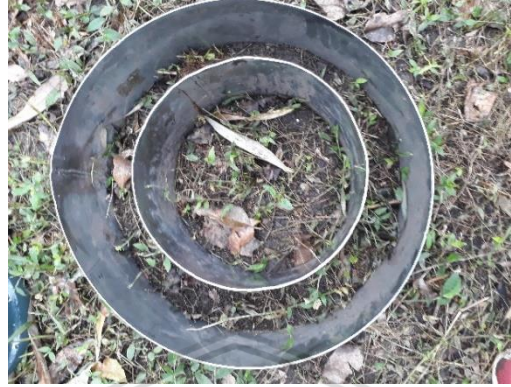
Gambar 2. Pengukuran dengan alat Double Ring
