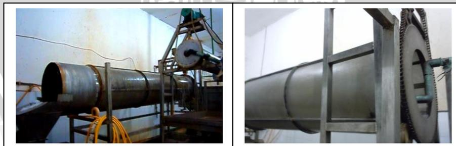
Gambar 19. Pencucian Keempat (*rotary sieve*)
