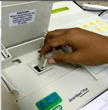
Dibaca dengan Spektrofotometri UV-Visibel panjang gelombang 200-400 nm , dicatat panjang gelombang maksimumnya
