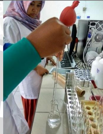
Ditambahkan aquabides ke dalam tabung reaksi larutan induk sampel, larutan induk pembanding, dan pada deret konsentrasi masing-masingsebanyak 10 ml
