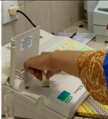
Diukur absorbansinya dengan spektrofotometer uv-vis dengan panjang gelombang 270 nm
