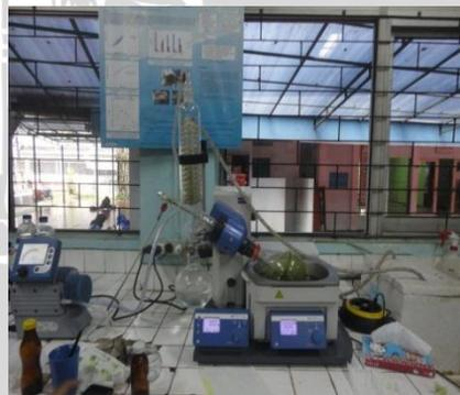
Dipisahkan pelarut dengan ekstraknya dengan alat evaporatory dengan suhu 40°C
