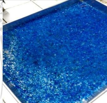
Silica gel setelah dioven dan dituang ke dalam desikator
