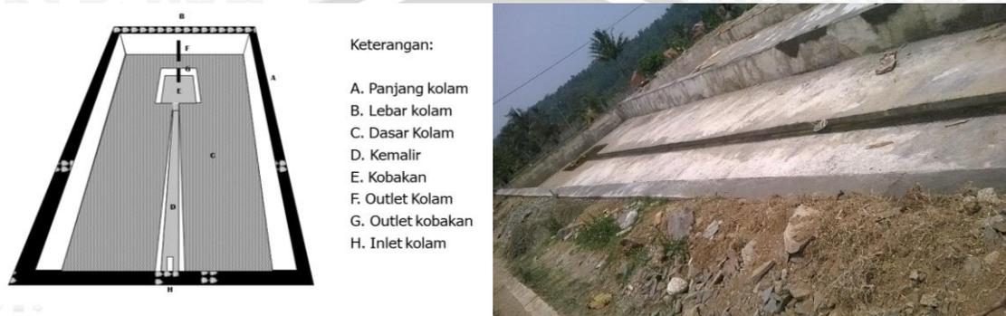
**Gambar 6.** Konstruksi Kolam
