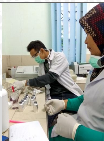
Diukur absorbansinya pada panjang gelombang 517 nm dan hasilnya di catat
