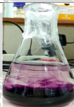
Ditimbang 4 mg serbuk DPPH dilarutkan dalam 100 ml aquabides
