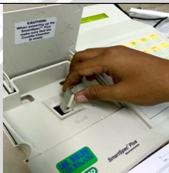
Dibaca dengan Spektrofotometri UV-Visibel panjang gelombang 200-400 nm , dicatat panjang gelombang maksimumnya
