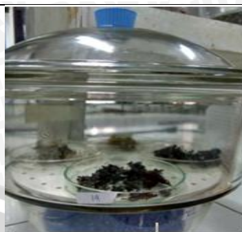
Sargassum sp. dimasukkan ke dalam cawan,dioven 6 jam (100-105°C) dan didesikator
