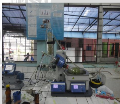
Dipisahkan pelarut dengan ekstrak dengan alat evaporatory dengan suhu 40°C
