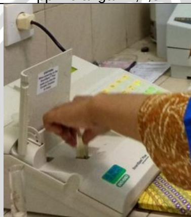
Diukur absorbansinya dengan spektrofotometer uv-vis dengan panjang gelombang 270 nm
