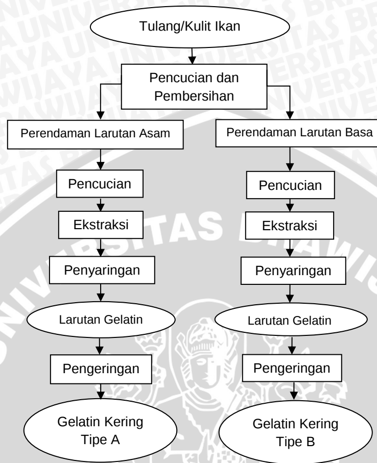
Gambar 6. Diagram Alir Proses Pembuatan Gelatin Dengan Cara Asam dan Cara Basa
