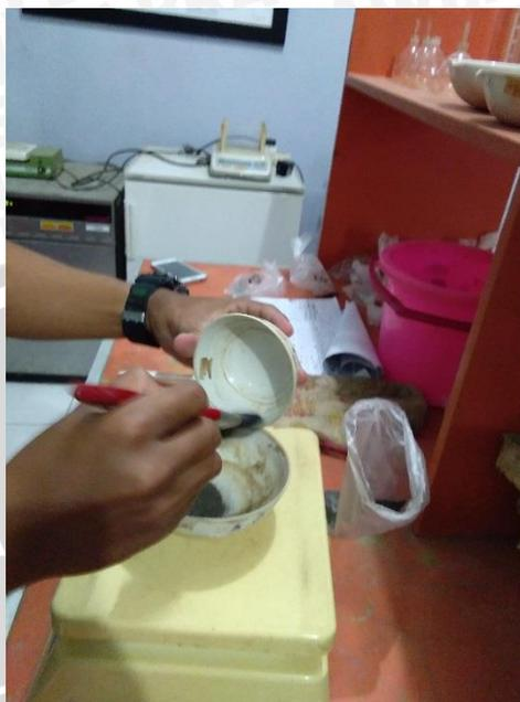
Analisis uji hidrometer (kiri) dan penimbangan sampel sisa uji hidrometer (kanan)
