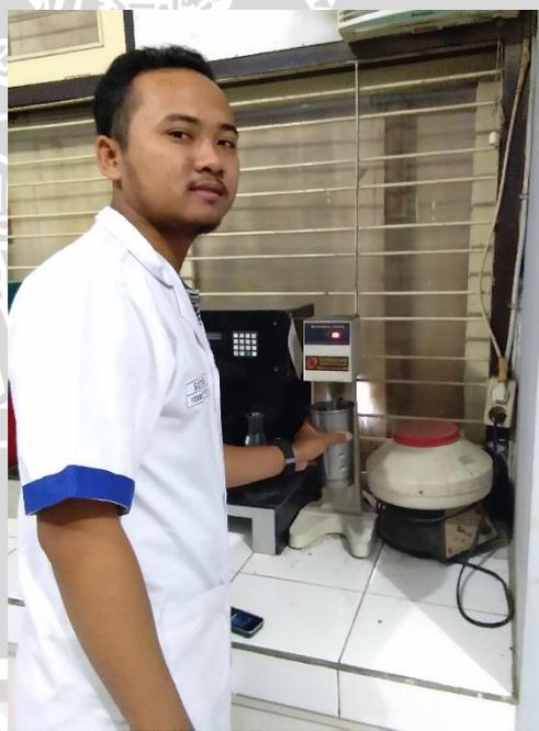
Pengovenan sampel sedimen (kiri) dan menghomogenkan sampel sedimen yang sudah di rendam selamat 24 jam (kanan)
