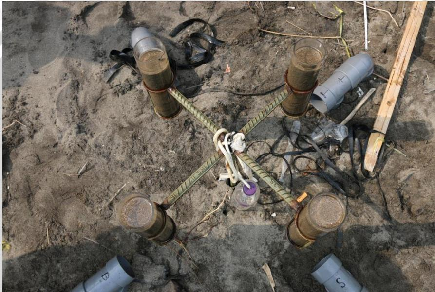
Gambar 25. Sediment trap nampak atas
