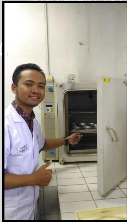
Gambar 17. Memasukkan Sampel Ayakan ke Dalam Oven
