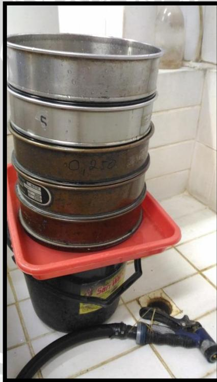
Gambar 15. Penyusunan Posisi Ayakan
