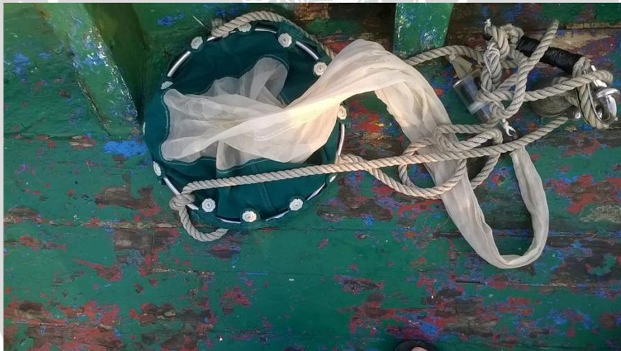
Gambar 21. Plankton Net untuk Zooplankton
