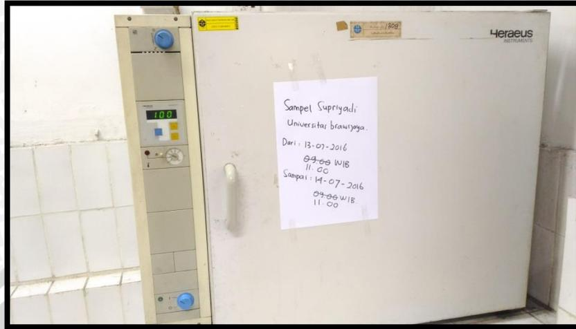
Gambar 11. Mengeringkan Sampel di dalam Oven
