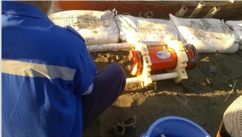
Gambar 22. ADCP untuk Mengukur Arus
