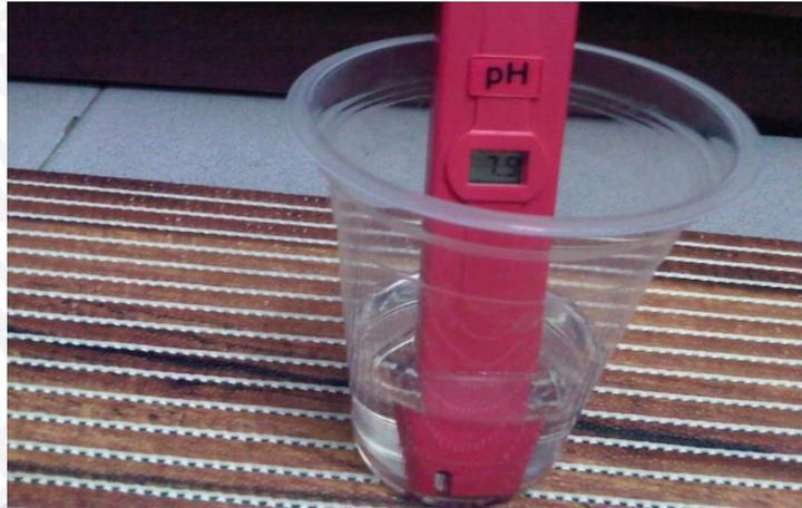
**Gambar 57. Pengukuran Kualitas Air (pH) Kolam Pembenihan dengan Menggunakan pH Meter Standard**
