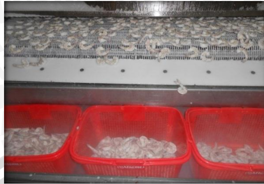
Gambar 14. Proses pembekuan IQF
