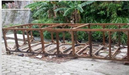
Gambar 2. Kerangka Karamba Bambu
