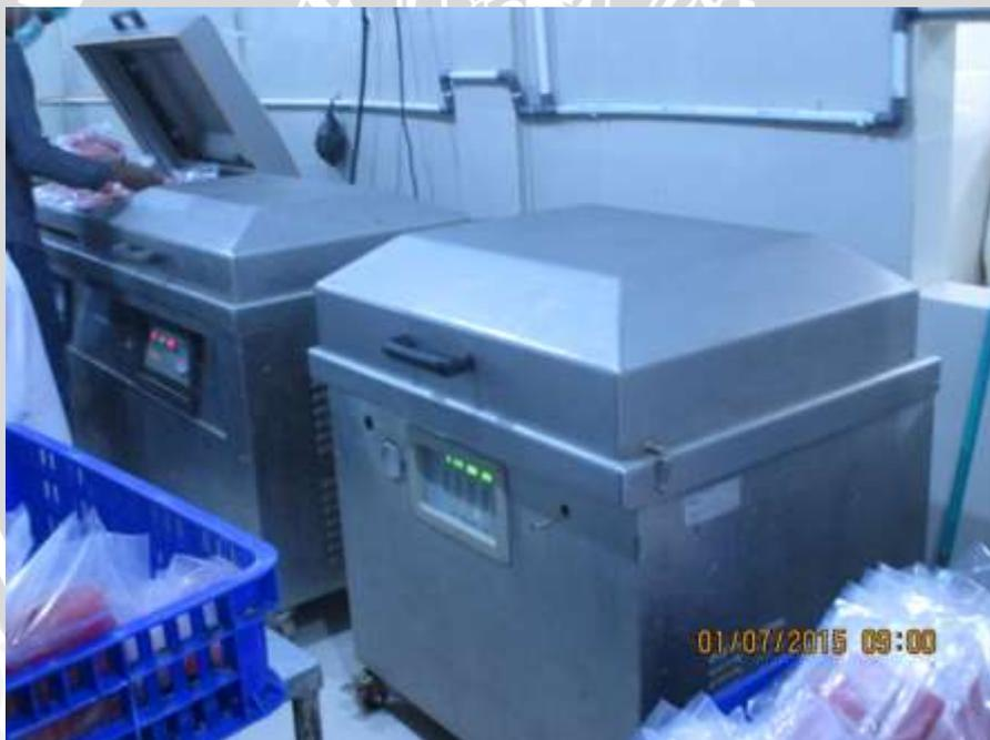
Mesin vakum yang digunakan pada produksi
