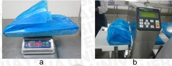
Gambar 22. (a) proses penimbangan produk jadi, dan (b) proses pengecekan metal produk jadi
