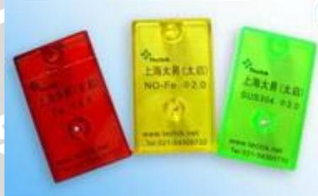
Gambar 17. *Test pin* / indicator adanya logam, non logam dan *stainless steel*
