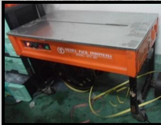
**Gambar 19. Alat untuk *Strapping Band***
