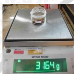
Berat botol timbang + sampel setelah dioven
