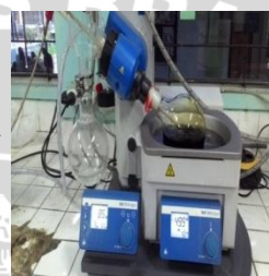
Evaporasi dengan vacuum rotary evaporator
