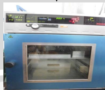
Pengeringan dengan oven vakum
