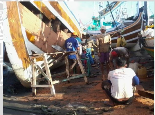
Penggantian Kayu Bagian Lambung Kapal
