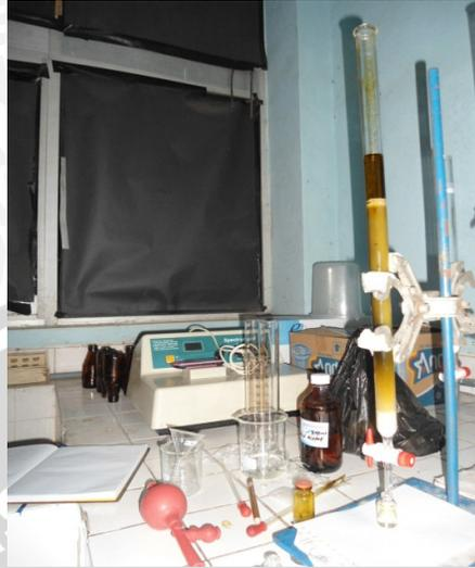
**Gambar 7. Kromatografi Kolom Ekstrak Etil asetat *A.granosa***
