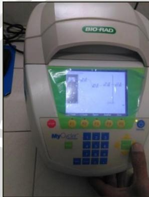
Pengoperasian Mesin PCR
