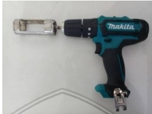
Gambar 9. Alat bor yang akan digunakan untuk mengambil mata tunas tebu
