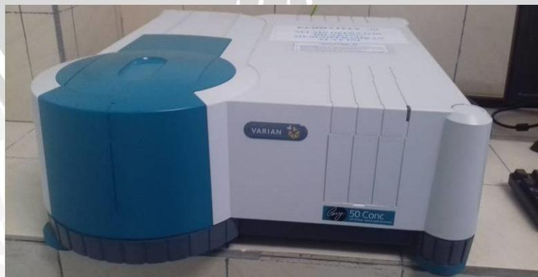
**Gambar 8.** Alat Spektrofotometer UV-Vis
