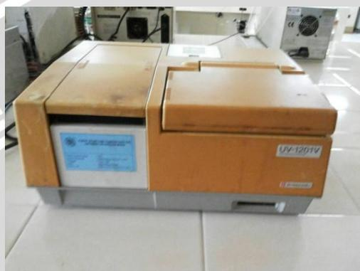
Gambar 15. Spektrofotometer UV-Vis
