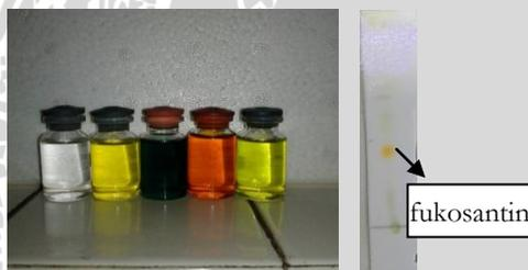
Gambar 1. Hasil Isolasi Kromatografi kolom dan KLT (Kromatografi Lapis Tipis)
