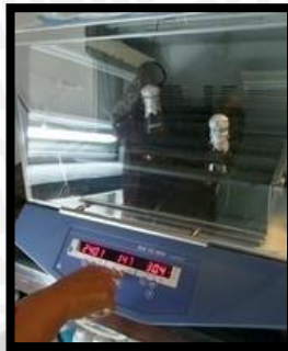
Media NB yang berisi bakteri dimasukkan dalam incubator shaker selama 48 jam
