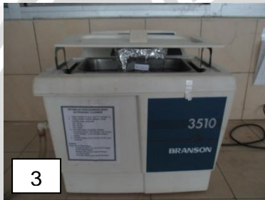
3. Diekstrak dengan gelombang ultrasonik frekuensi 50 kHz selama 45 menit.
