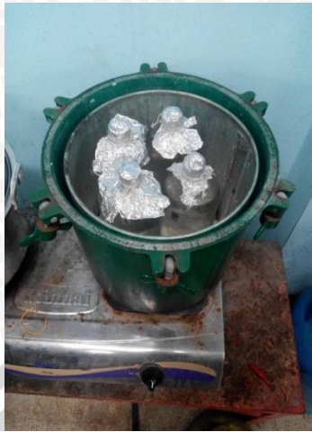
a. Sterilisasi air laut didalam autoklaf manual
