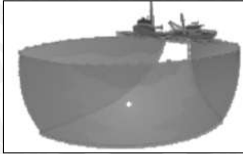
Gambar 6. Pukat Cincin dengan dua Kapal (KEPMEN No.6, 2010)
