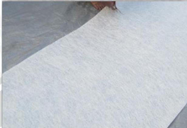
Gambar 12. Jenis serat *fiberglass* yang digunakan dalam laminasi
