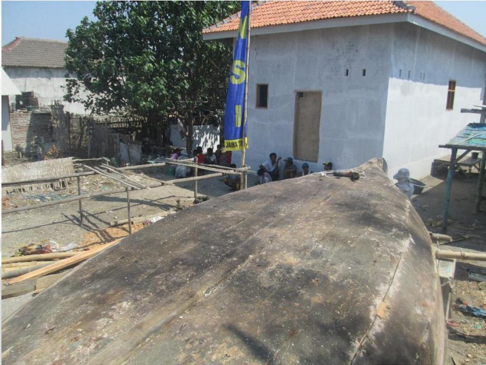
Bentuk lambung sebelum di laminasi *fiberglass*
