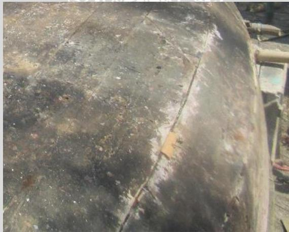
Gambar 7. Lubang pada lambung
