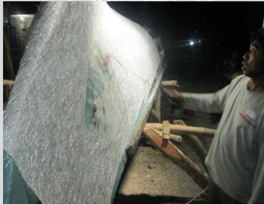
Gambar 19. Laminasi pertama dengan satu lapisan
