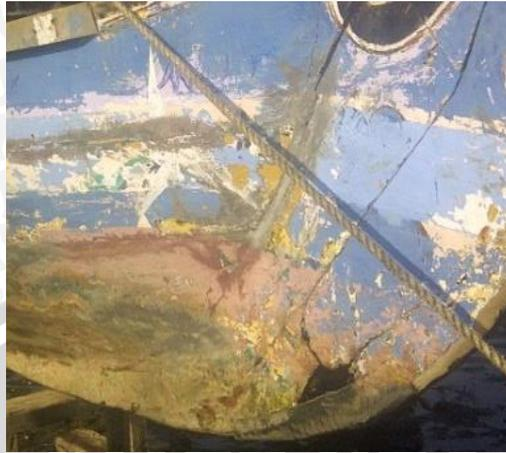
Gambar 5. Papan lambung patah
