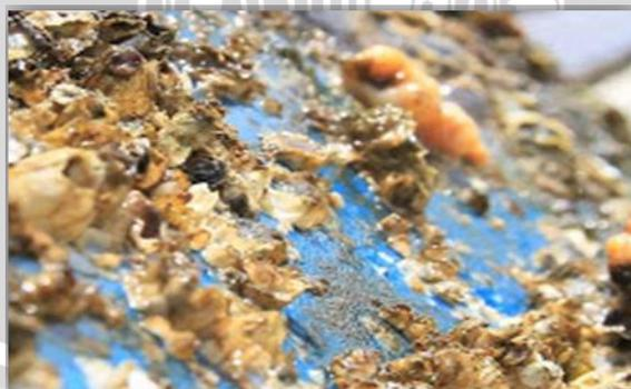
Gambar 3. Kerak pada bagian lambung
