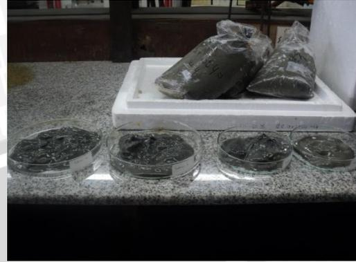
Penempatan sampel sedimen pada cawan petri
