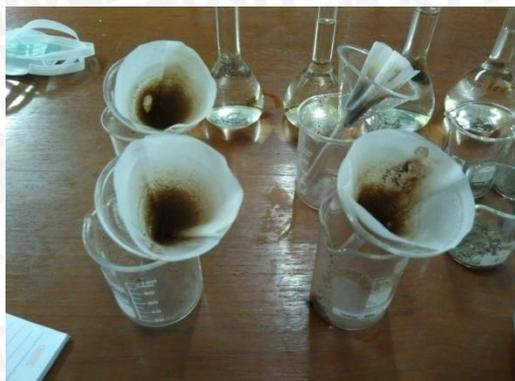
Proses ekstraksi bubuk halus sampel sedimen dengan HNO<sub>3</sub>
