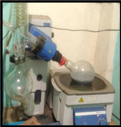
Ekstrak tinta cumi-cumi pelarut n-heksan di evaporasi dengan alat *Vaccum Rotary Evaporator*
