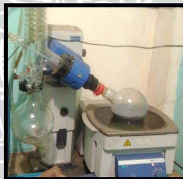
Dilakukan pemisahan pelarut dengan *Vaccum Rotary Evaporator*
