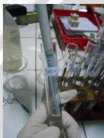
Penambahan 250 \mu L enzim \alpha -glukosidase sebagai S_1 dan penambahan 250 \mu L buffer fosfat pH 7 sebagai S_0
