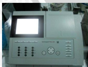
Pengukuran absorbansi sampel dengan spektrofometer UV-Vis \lambda 760
