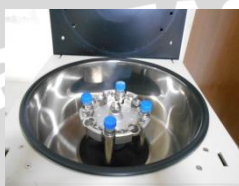
Disentrufuge 3000 rpm selama 10 menit
