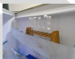
Diinkubasi dalam refrigrasi suhu 4 °C selama 15 menit
