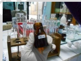
Penambahan 250 \mu L enzim \alpha -glukosidase sebagai S_1 dan penambahan 250 \mu L buffer fosfat pH 7 sebagai S_0
