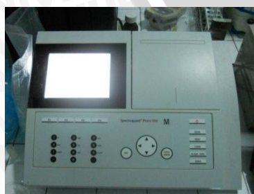
Pengukuran absorbansi sampel dengan spectrofometer UV-Vis \lambda 550 nm
