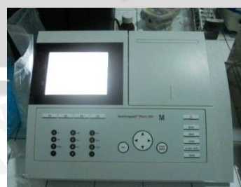
Pengukuran absorbansi sampel dengan \lambda 400 nm
