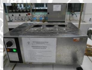
Diinkubasi dengan suhu 97-100 °C dalam waterbath
