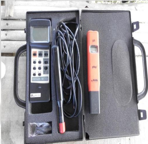
Prosedur dalam pengukuran DO dan suhu menggunakan DO meter
