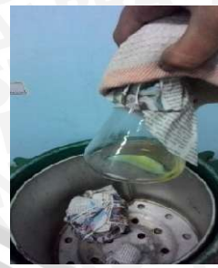
3. Proses sterilisasi suhu 121°C selama 15 menit
