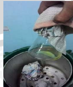
10. Proses sterilisasi suhu 121°C selama 15 menit
