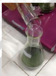
16. Pemberian pelarut etanol (1:5)
