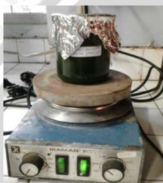
4. Maserasi sampel dengan alat pengaduk
