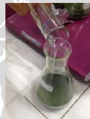
9. Pemberian pelarut etil asetat perbandingan 1:5
