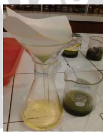
5. Penyaringan hasil maserasi dengan pelarut heksan
