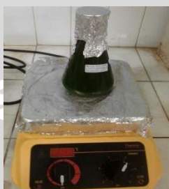
17. Maserasi sampel dengan alat pengaduk
