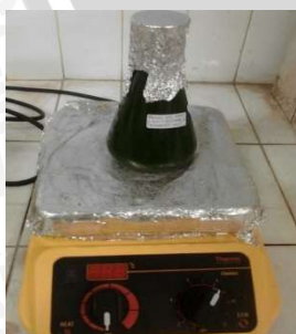
10. Maserasi sampel dengan alat pengaduk
