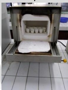
Proses pengabuan pada suhu 600°C hingga berwarna abu
