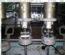
Proses ekstraksi dengan gold fisch selama 3 jam
