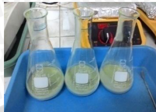
Sampel dimasukan 3 erlenmeyer 250 ml (24jam,48jam,72jam)
