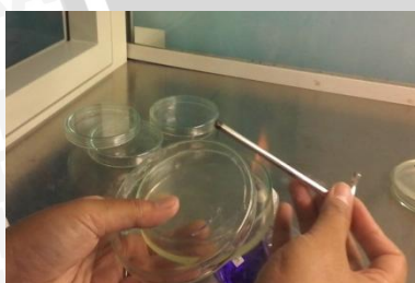
Dilakukan pelubangan pada media yang telah membeku dengan besi sumuran
