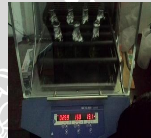
Di shaker waterbath dengan kecepatan 150rpm suhu 27 0 C
