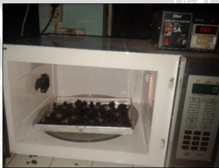
5. Pengeringan dengan vacuum dryer dengan suhu 80 °C selama 20 menit
