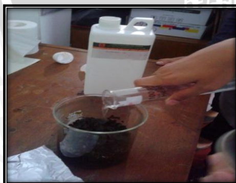
5. Penambahan metanol untuk maserasi selama 2x24 jam
