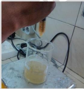
8. Pengekstruksian ke dalam KCl 3,9 M 75 mL
