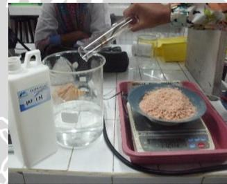
5. Demineralisasi NaOH 3,5% (Pencampuran HCl 1 N perbandingan 1:10 pada suhu 60-65°C selama 60 menit
