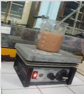
9. Deasetilasi (pencampuran dengan NaOH 20% W pada suhu 90-100°C selama 60 menit
