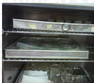
Pengeringan cawan petri dalam oven bersuhu 105°C selama 24 jam dengan tutup setengah terbuka
