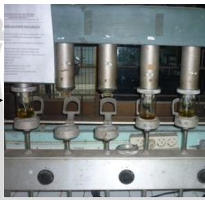
Pengekstraksian lemak pada goldfish selama 3 jam
