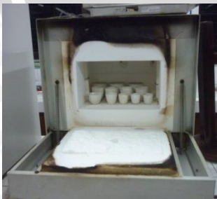
Pengabuan dalam muffle bersuhu 600°C
