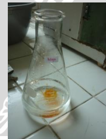
Penambahan 50 mL H_3BO_3 dan 1 tetes metyl orange ke dalam erlenmeyer
