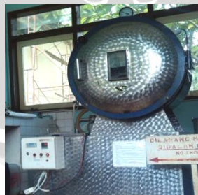
Pengeringan dalam oven vakum dengan suhu 55°C
