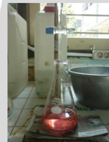
Pentitrasi destilat dengan H_2SO_4 N hingga berubah warna merah muda
