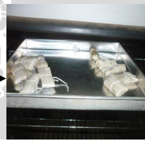
Pengeringan sampel pada suhu 105°C selama 24 jam
