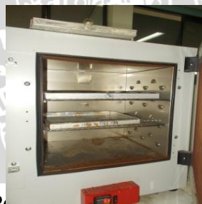
Pengeringan cawan petri dalam oven bersuhu 105°C selama 3 jam dengan tutup setengah terbuka
