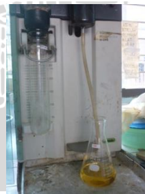
Pendestilasi selama 3 menit dan destilat ditampung pad erlenmeyer
