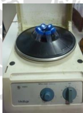
Penghomogenan dengan sentrifuse dengan kecepatan 7500 rpm selama 5 menit
