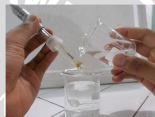
Pembilasan elektroda pH meter menggunakan aquadess
