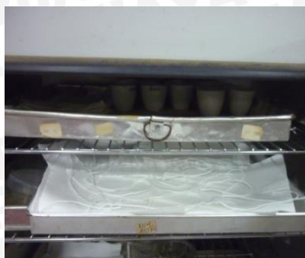
Pengeringan kertas saring dan benang kasuri dalam oven bersuhu 105°C selama 24 jam
