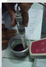
Pencelupan elektroda pada sampel
