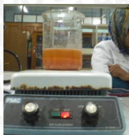
(14) Dipanaskan dan dihomogenkan diatas hotplate suhu 90°C
