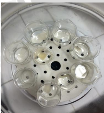
(5) Sampel dimasukkan kedalam desikator
