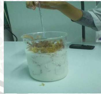
(7) Penghomogenan rumput laut dengan larutan \text{Ca}(\text{OH})_2
