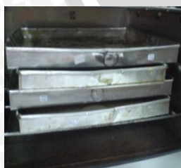
(12) Dikeringkan dalam oven suhu 65°C
