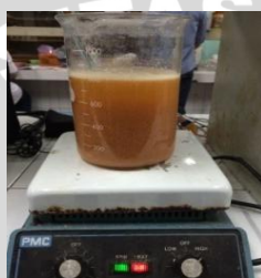
(5) Dihomogenkan dan di panaskan diatas hotplate 85oC
