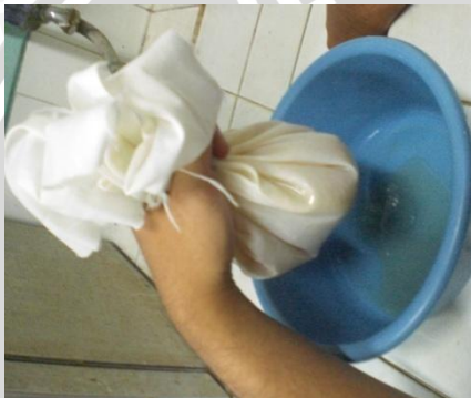
(9) Dilakukan pemerasan sampai pH netral
