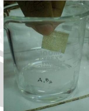
(2) Sampel di potong dengan ukuran 2x2 cm dan dimasukkan
