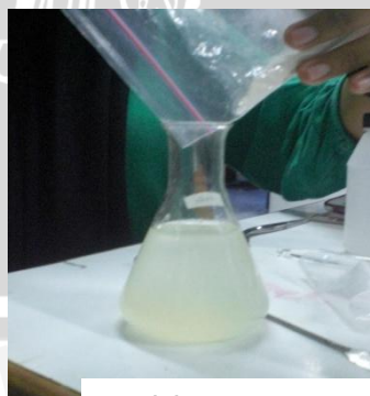
(6) Pencampuran larutan kitosan dengan kappa dan iota karaginan
