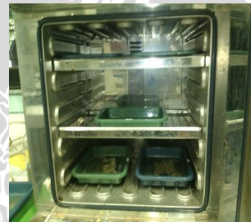
(10) Pengeringan Edible Film dengan suhu 60°C
