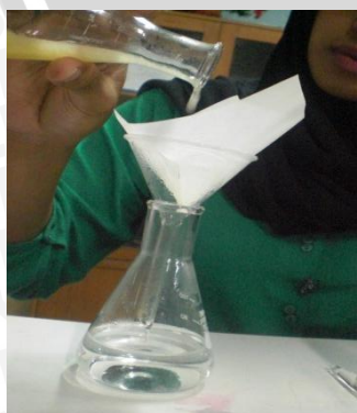
(5) Penyaringan larutan kitosan
