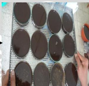
Hidrolisat diletakkan pada cawan petri sebelum divacum
