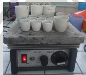
Pengarangan di atas hot plate sampai tidak mengeluarkan asap
