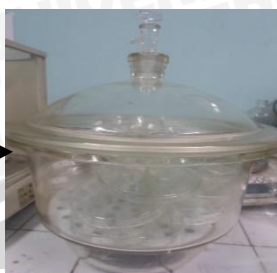
Pendinginan dalam desikator selama 15 menit
