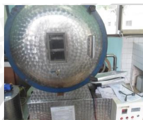
Pengeringan dalam oven vakum dengan suhu 55°C
