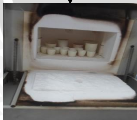
Pengabuan dalam muffle pada suhu 600°C
