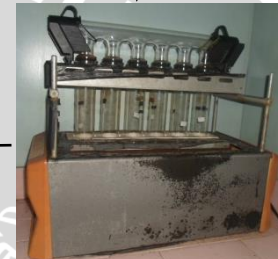
Penuangan sampel, tablet kjeldahl dan 15 mL H_2SO_4 ke dalam labu destruksi dan pemanasan pada suhu 370^{\circ}C selama 3 jam
