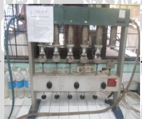
Pengekstrasian lemak pada goldfish selama 3 jam
