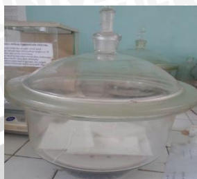
Pendinginan dalam desikator selama 15 menit
