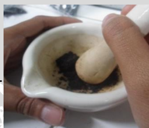
Penghalusan sampel dari kadar air
