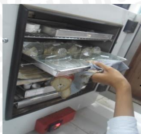
Pengeringan cawan petri dalam oven pada suhu 105°C selama 24 jam dengan tutup setengah terbuka
