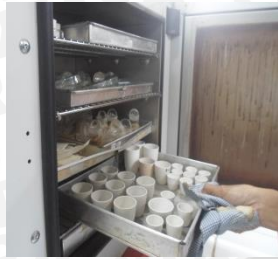
Pengeringan cawan porselen pada suhu 105°C selama 24 jam
