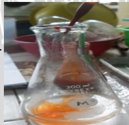
Penambahan 1,5 gram H_3BO_3 , dan akuades 50 mL, dan metyl orange ke dalam erlenmeyer
