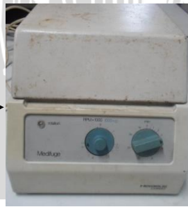
Penghomogenan dengan sentrifuge dengan kecepatan 7500 rpm sekama 5 menit
