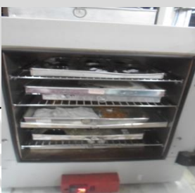
Pengeringan dalam oven dengan suhu 105°C selama 3 jam dengan tutup setengah terbuka
