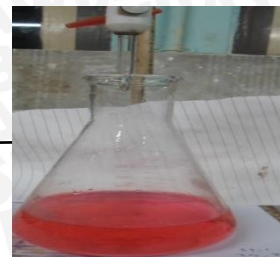
Penitrasi destilat dengan H_2SO_4 0,4 N hingga berubah warna merah muda
