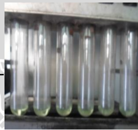
Sampel hasil destruksi berwarna kehijauan
