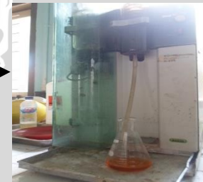
Pendestilasi selama 3 menit dan destilat ditampung pada erlenmeyer
