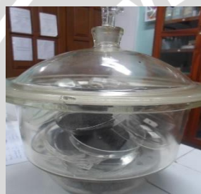
Pendinginan dalam desikator selama 15 menit
