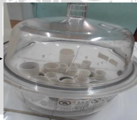
Pendinginan dalam desikator selama 15 menit
