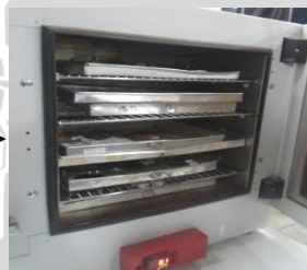
Pengeringan sampel pada suhu 105°C selama 24 jam
