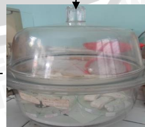
Pendinginan dalam desikator selama 15 menit
