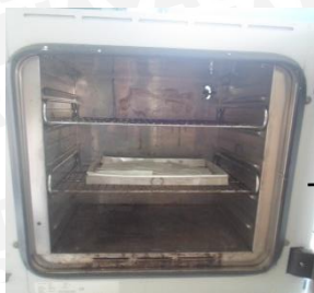
Pengeringan kertas saring dan benang kasur pada suhu 105°C selama 24 jam
