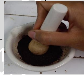
Penghalusan sampel dari kadar lemak
