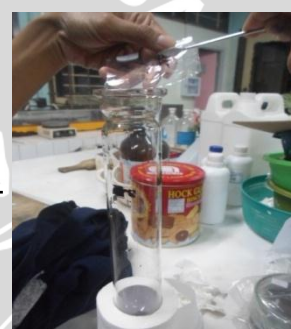
Penuangan sampel dan tablet kjeldahl 2 gram
