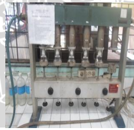
Pengekstrasian lemak pada goldfish selama 3 - 4 jam
