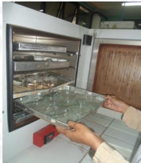
Pengeringan cawan petri dalam oven pada suhu 105°C selama 24 jam dengan tutup setengah terbuka
