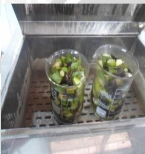
Penambahan akuades b/v (1:2) dan perebusan dengan waterbath suhu 55°C selama 15 menit
