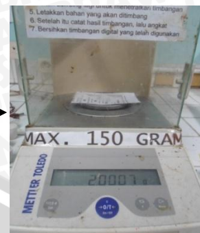
Penimbangan tablet kjeldahl sebanyak 2
