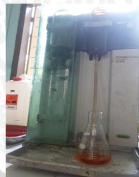
Penambahan H_2O dan NaOH dan pendestilasian selama 3 menit dan destilat ditampung pada erlenmeyer
