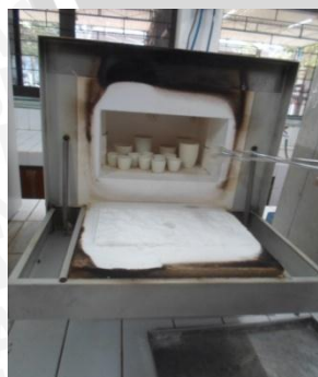
Pengabuan dalam muffle pada suhu 600°C sampai sampel berwarna putih
