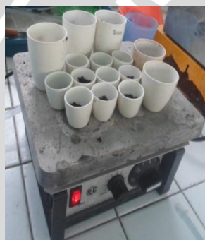
Pengarangan di atas hot plate sampai tidak mengeluarkan asap
