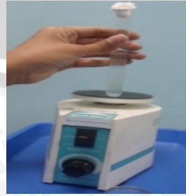
Penghomogenan dengan vortex mixer
