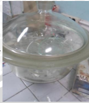
Pendinginan dalam desikator selama 15 menit
