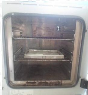
Pengeringan kertas saring dan benang kasur pada suhu 105°C selama 24 jam
