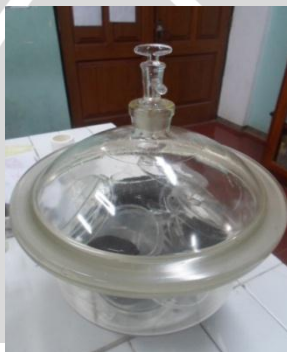
Pendinginan dalam desikator selama 15 menit
