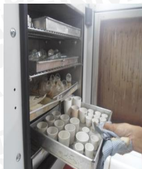
Pengeringan cawan porselen pada suhu 105°C selama 24 jam
