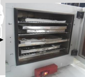
Pengeringan sampel pada suhu 105°C selama 24 jam
