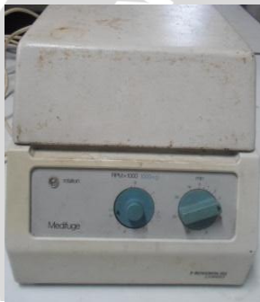
Penghomogenan dengan sentrifuge dengan kecepatan 7500 rpm sekama 5 menit
