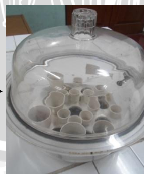
Pendinginan dalam desikator selama 15 menit
