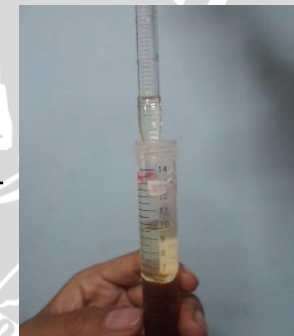
Penambahan minyak jagung sebanyak 5 mL ke dalam cuvet
