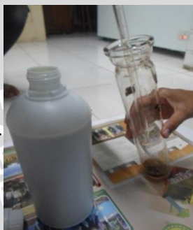
Penambahan 15 mL H 2 SO 4 ke dalam labu destruksi
