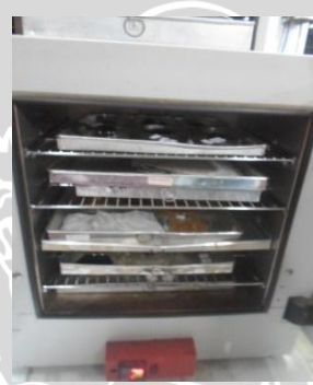
Pengeringan dalam oven dengan suhu 105°C selama 4 jam dengan tutup setengah terbuka
