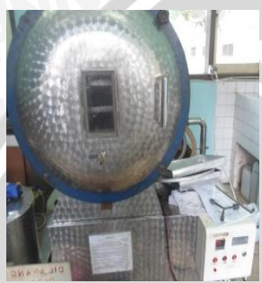
Pengeringan dalam oven vakum dengan suhu 55°C
