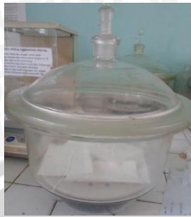
Pendinginan dalam desikator selama 15 menit
