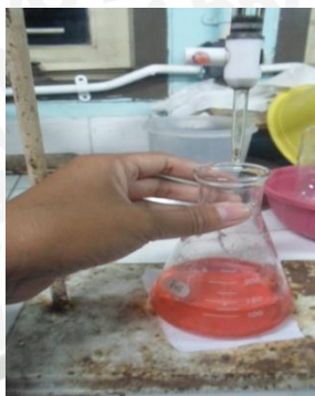
Penitrasian destilat dengan H_2SO_4 0,4 N hingga berubah warna merah muda
