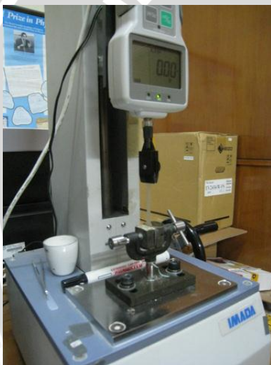
Pengujian tensile strength dan perpanjangan
