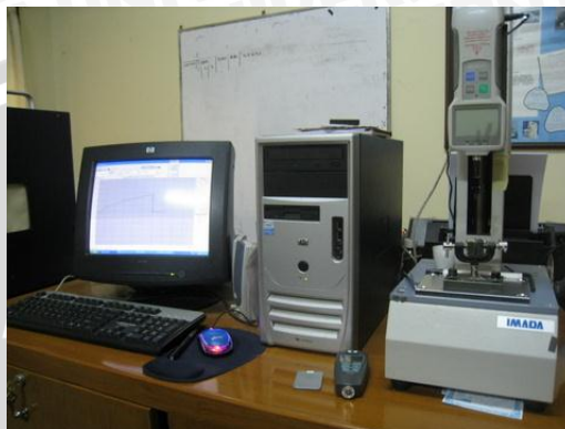
Alat untuk uji tensile strength
