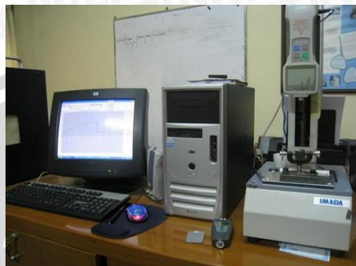
Alat untuk uji *tensile strength*
