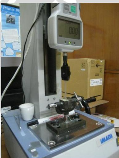
Alat uji *tensile strength* dan perpanjangan
