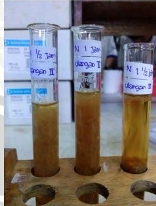
b) Pencampuran sampel dalam tabung reaksi dengan akuades 15 mL
