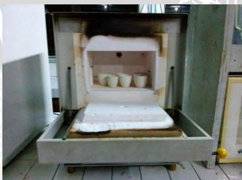
e) Pengabuan endapan pada muffle suhu 700°C selama 1 jam
