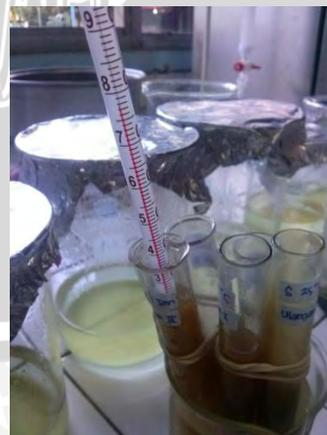
f) Pengukuran suhu *melting point* menggunakan termometer
