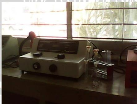
**Gambar 17. Pengujian Logam Berat Dengan Spektrofotometer**
