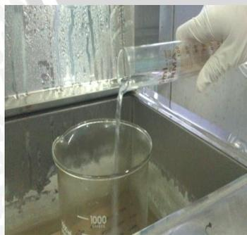
Ditambahkan CaCl<sub>2</sub> 10% : filtrate (1:5) dengan pemanasan 40 °C sehingga mengalami penggumpalan
