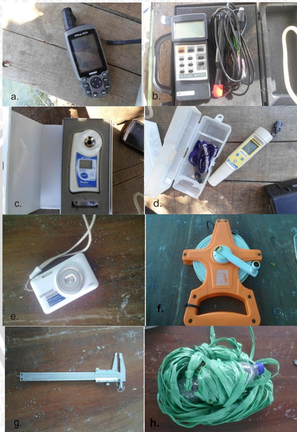
Gambar 39. a. Gps Garmin, b. Do Meter, c. Salino meter, d. Ph meter, e. Kamera digital, f. Roll meter (meteran), g. Jangka sorong, h. Tali rafia
