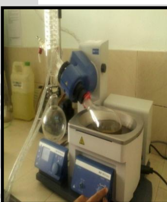
e. Di rotary dengan suhu 50° C hingga pelarut tak bersisa
